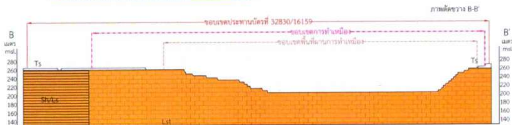
ภาพแสดงขอบเขตการทำเหมือง และภาพตัดขวางแหล่งแร่
